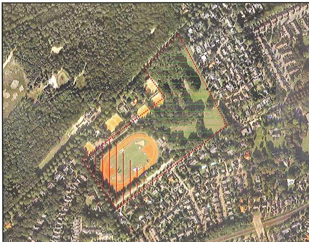
Figuur 2.1: Luchtfoto plangebied met weergave infiltratiemogelijkheden (groen: infiltratie mogelijk, rood: infiltratie niet mogelijk)
