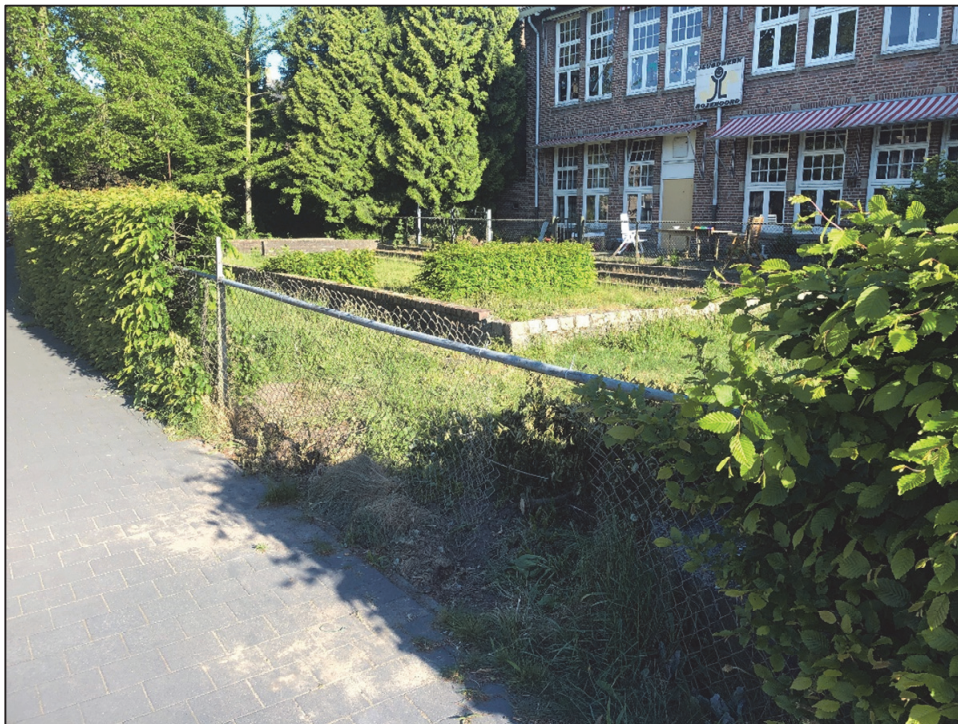
Afb. 3.2.2.3. – Hekwerk rond de projectlocatie zorgt voor verstoring van de detectie. Ook de gemetselde bak langs de Secretaris van Rooijstraat kan zorgen voor verstoring op de detectiedata.
