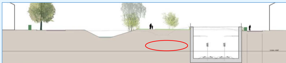
figuur 3: Tijdelijke situatie: ligging tijdelijke sporen (rode omcirkeld) ten opzichte van tunnelbak in aanleg.
