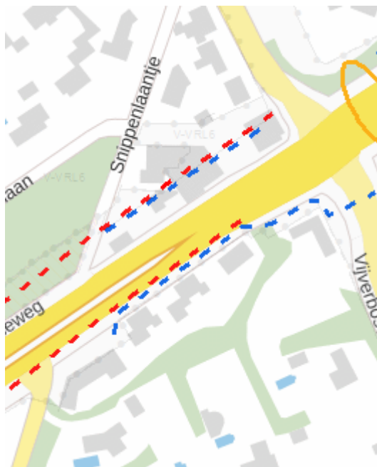
Figuur 4-8: Verlegging van het hemelwaterriool zie rode stippellijn (bron: Pimplatform, maart 2019). Aanvullend merkt de gemeente op dat er nog een kruisende rioolleiding verlegd moet worden.
