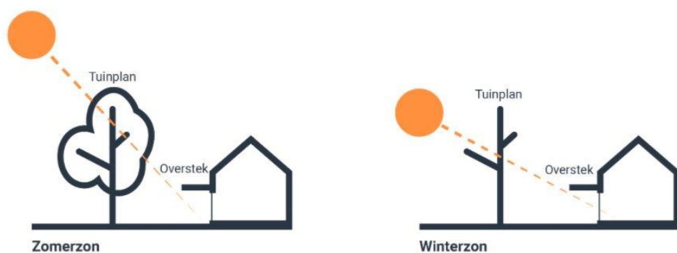
Figuur 6 Schematische weergave mogelijkheid voor zonwering in zomer
