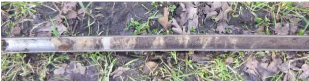
Figuur 21: Foto van de sterk vergraven tussenlaag
