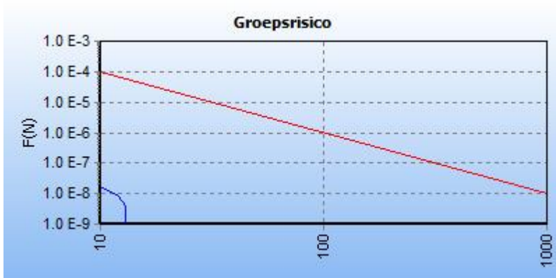
5.2 Figuur 5.2 FN curve voor 6720_leiding-A-645-deel-1 van N.V. Nederlandse Gasunie voor de kilometer tussen stationing 1820.00 en stationing 2820.00
