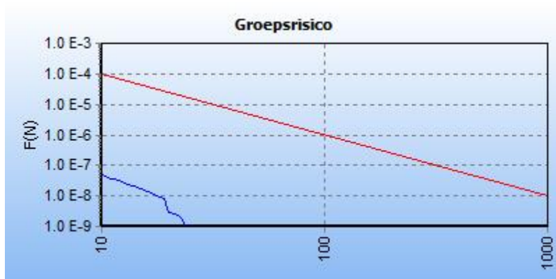
5.5 Figuur 5.5 FN curve voor 6720_leiding-Z-504-03-deel-1 van N.V. Nederlandse Gasunie voor de kilometer tussen stationing 0.00 en stationing 1000.00
