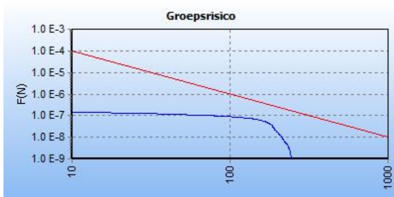
5.2 Figuur 5.2 FN curve voor 6720_leiding-A-645-deel-1 van N.V. Nederlandse Gasunie voor de kilometer tussen stationing 1920.00 en stationing 2920.00
