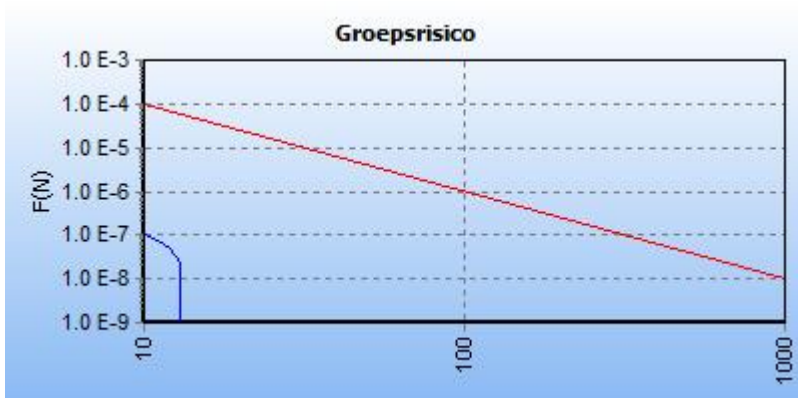
5.2 Figuur 5.2 FN curve voor 6720_leiding-A-645-deel-1 van N.V. Nederlandse Gasunie voor de kilometer tussen stationing 1820.00 en stationing 2820.00
