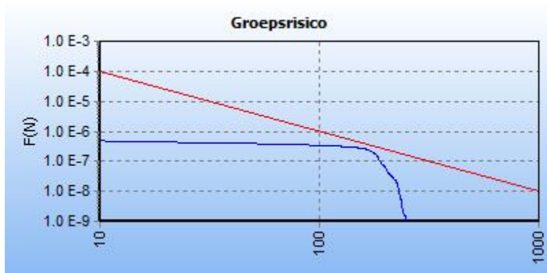
5.2 Figuur 5.2 FN curve voor 6720_leiding-A-645-deel-1 van N.V. Nederlandse Gasunie voor de kilometer tussen stationing 1920.00 en stationing 2920.00
