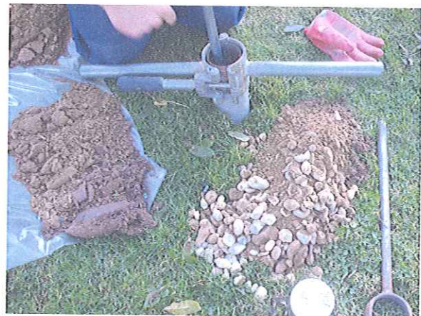
Foto 4. gebruikmaking van de casing bij boring 04.
