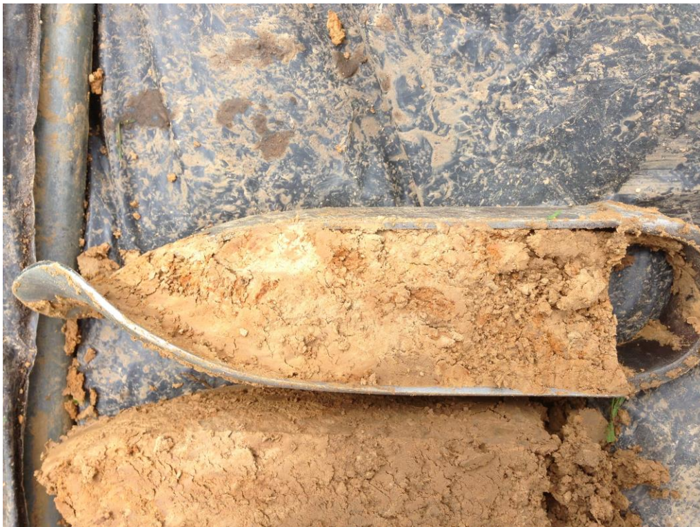
Boring 2: detailopname witte uitspoelingsvlekken en oranje-bruine roestvlekken (gleyverschijnselen), als gevolg van hangwater. Traject tussen 40 – 140 cm –Mv
