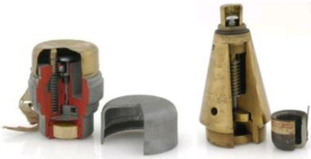
Figuur 6: Voorbeelden schokontstekers
