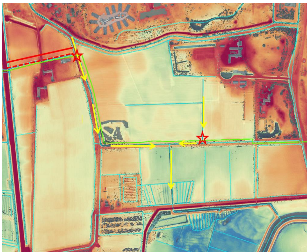
Figuur 3-2: Schematische weergave van aanpassingen aan het watersysteem voor variant B10. Hierbij is het tracé in lichtgroen weergegeven en de werking van het huidige watersysteem in geel. In rood zijn de knelpunten met een stervorm weergegeven, hier dienen afsluitbare duikers of voorzieningen voor noodpompen geplaatst te worden. De te verplaatsen sloot is linksboven weergegeven (met in rood gestippeld de huidige locatie en in rood doorgetrokken lijn de nieuwe locatie).
