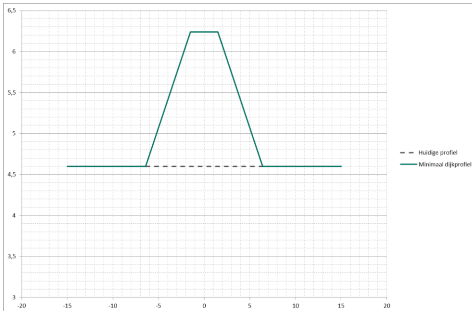
Figuur 2-6: Geometrisch profiel sectie Midden
