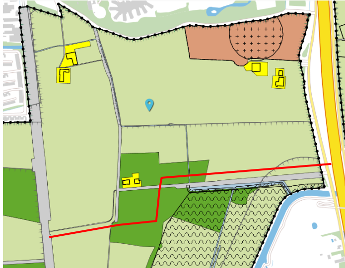
Figuur 9-23: Bestemmingsplan Buitengebied 2011 Vught, met in rood indicatief het tracé van de nieuwe kering.
