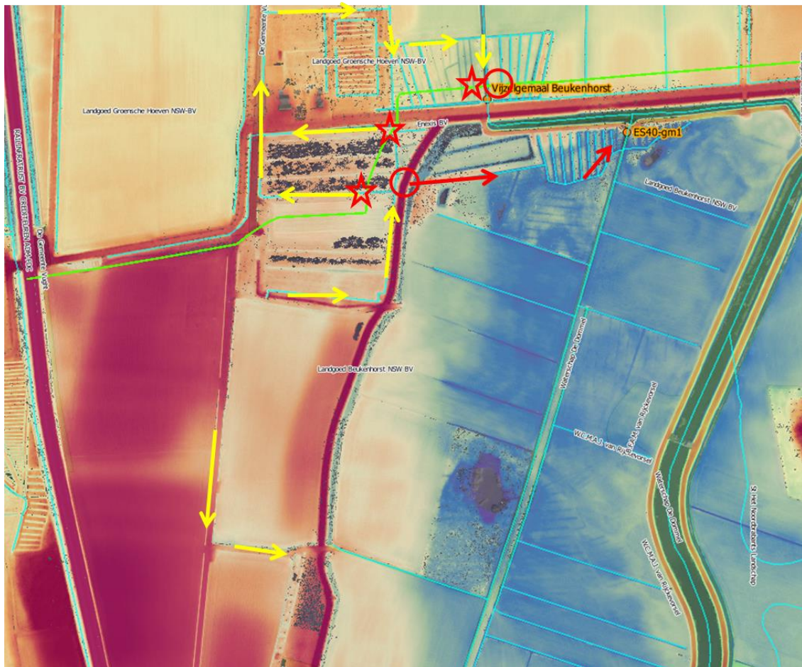
Figuur 3-3: Schematische weergave van het watersysteem (zuidzijde). Hierbij is het geplande tracé van variant B11 in lichtgroen weergegeven en de werking van het huidige watersysteem in geel. In rood zijn de knelpunten met een stervorm weergegeven, de locaties van de te plaatsen afsluitbare duikers (indicatief) met cirkels en de nieuwe 'route' met pijlen.
