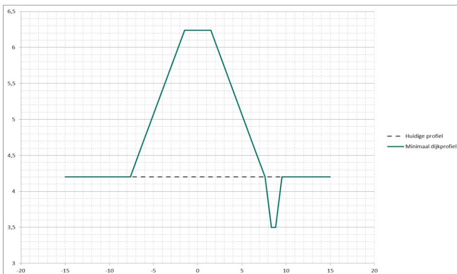
Figuur 2-7: Geometrisch profiel sectie Beukenlaan
