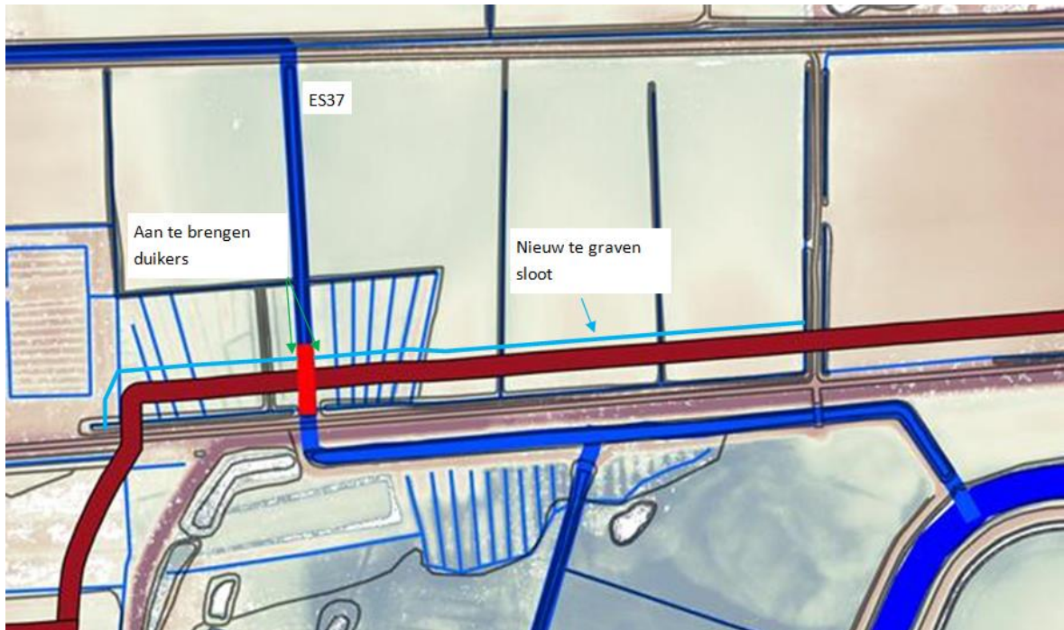
Figuur 3-8: Aanpassingen watersysteem in sectie Beukenlaan.
