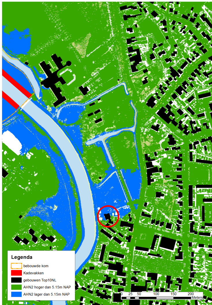
Figuur 3-5: Overstromingsbeeld bij Sint Michielsgestel voor een gebouw binnen bebouwde kom direct vanuit de Dommel
